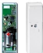
Dispositivo radio bidirezionale per collegamento con sensori esterni a basso assorbimento.
