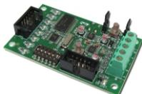
Modulo satellite per espandere le linee di uscita delle centrali AXO' 404 e AXTRA.
