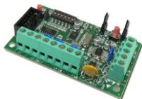
Modulo satellite per espandere le linee di ingresso delle centrali della serie AXO' 404 e AXTRA con possibilità di gestione anche dei contatti a fune per tapparella ("switch-alarm" e rilevatori passivi di shock non piezoelettrici).
