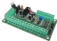
Modulo satellite per espandere le linee di ingresso delle centrali della serie AXO' 404 e AXTRA con possibilità di gestione anche dei contatti a fune per tapparella ("switch-alarm" e rilevatori passivi di shock non piezoelettrici).
