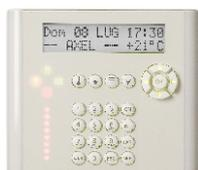
Tastiera a display con retroilluminazione verde temporizzata, per la completa gestione e programmazione delle centrali della serie AXO' 404 e AXTRA.
