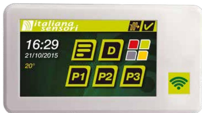
Tastiera filare con display touch LCD collegabile tramite BUS a tutte le centrali Linea ORO 869.
