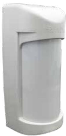
Rivelatore ITALO via radio tripla tecnologia da esterno con portata fino a 1.500 m in aria libera. Rivelazione tramite 2 PIR ed una microonda a 24 GHz, altezza di installazione 1 ÷ 1,2 m con copertura di 12 m ed apertura di 85°. Impostazioni eseguibili direttamente dalla centrale quali settaggi AND/OR (triplo AND, doppio OR, l'esclusione della microonda, ecc.), sensibilità dei PIR, portata della microonda e della rivelazione al mascheramento.
