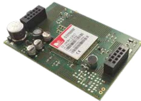
Scheda programmatore telefonico GSM e GPRS da alloggiare all'interno delle centrali della Linea ORO, completa di messaggi vocali sullo stato allarme e risponditore, rubrica di 16 numeri, credito residuo della SIM attraverso SMS (TIM, Vodafone, Wind).
