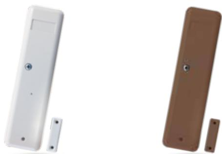
Contatto via radio perimetrale a lunga portata con portata fino a 1.500 m in aria libera, per la protezione di infissi e porte, compatibile con le centrali serie GOLD 869. Trasmissione bidirezionale con la centrale, estremamente compatto ed alimentato da una pila al litio AA 3,6 V 2.200 mAh (fornita).
