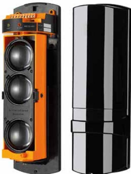
Barriera RICK infrarossi a lunga portata adatta per la protezione di interni ed esterni ed utilizzabile sia per la protezione di uffici che di strutture private. È caratterizzata da contenitore in policarbonato, uscita NA/NC, grado di protezione IP65. È funzionante anche in presenza di cattive condizioni atmosferiche. Montaggio su muro o su palo (Ø 38 - 50 mm). Numero di fasci: 3. Distanza di rivelamento: 200 m (esterno); 600 m (interno).
