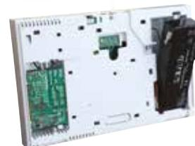
Massima praticità di manutenzione, è possibile sostituire la batteria semplicemente staccando la centrale dal supporto senza necessità di aprirla.
