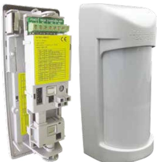
Il rivelatore ITALO da esterno, composto da 2 sensori infrarossi dual PIR ed una microonda con cavità planare, è stato progettato e realizzato per garantire le massime prestazioni in ambiente esterno. L'elettronica del rivelatore è orientabile e permette di ottenere una copertura orizzontale di 85° distribuiti su un piano di 170°. Il fissaggio del rivelatore può essere sia a parete che su palo (altezza 1 ÷ 1,2 m).
