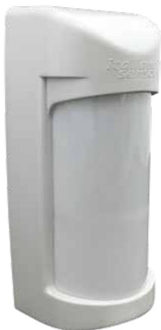
Il rivelatore da esterno a tenda ITALO180 è composto da 5 sensori passivi dual PIR, 2 microonde da 24 GHz e 5 IR attivi, gestiti da un sofisticato algoritmo. L'elettronica particolarmente evoluta è stata progettata per garantire le massime prestazioni in ambiente esterno. La protezione è a tenda con 2 fasci laterali (a 180°) di 5° (con portata massima 15 m per lato) e uno frontale, sempre di 5° (portata massima 1 m), con funzione di antiavvicinamento.
