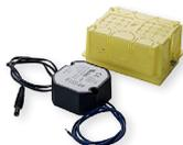
Alimentatore stabilizzato 12Vdc - 1,5A in contenitore IP67, può essere fissato tramite 2 viti da 3mm. Collegamento alla rete 230Vac tramite due fili pre-stagnati (50.0x48.0x25.0mm)
